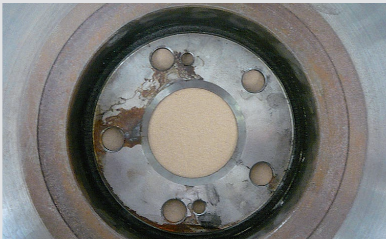
► 刹车盘支座区域出现裂痕
