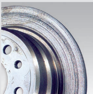
► 刹车盘由于摩擦材料磨损而造成损坏
