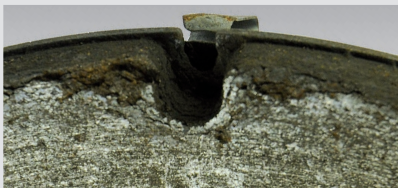
► 表面脱落，无高热应力迹象
