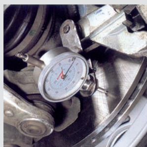
► 测量车辆的刹车盘跳动
