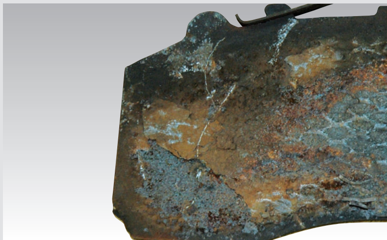
► 底垫受到严重腐蚀
