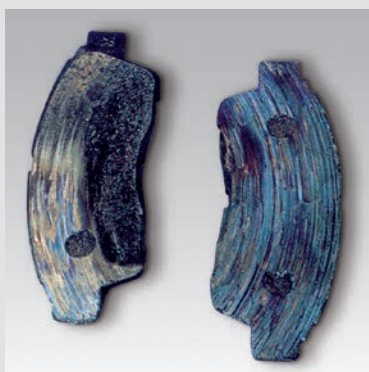
► 摩擦材料磨损至钢底板
