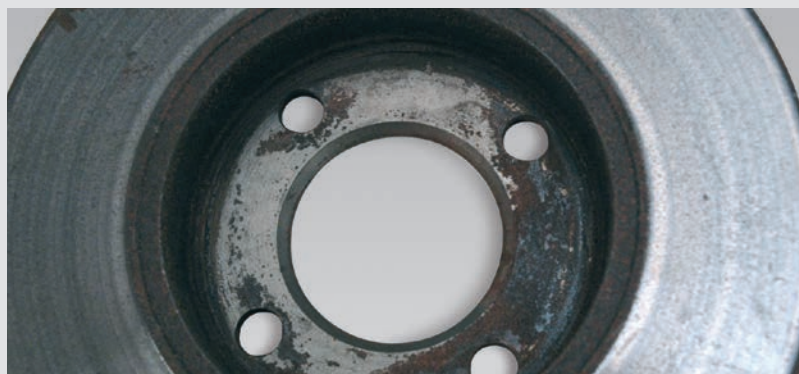
► 接触面受到严重腐蚀
